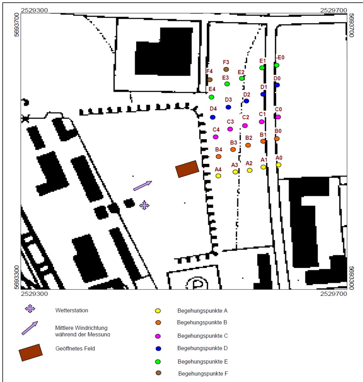
Abb. 2: Anordnung der Schnittlinien und Messpunkte während der Geruchsfahnenkartierungen
