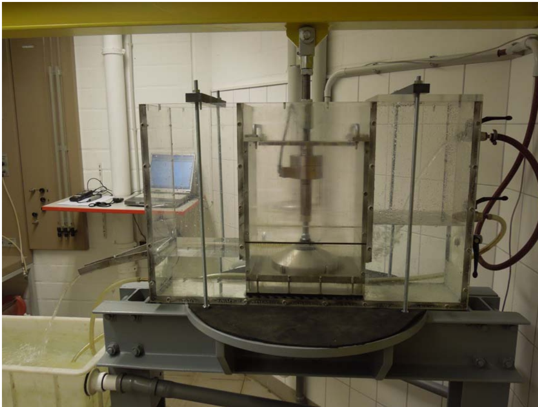
Abb. 2: Gerät im Laboreinsatz (GB Düllmann GmbH) mit Belastungseinrichtung
